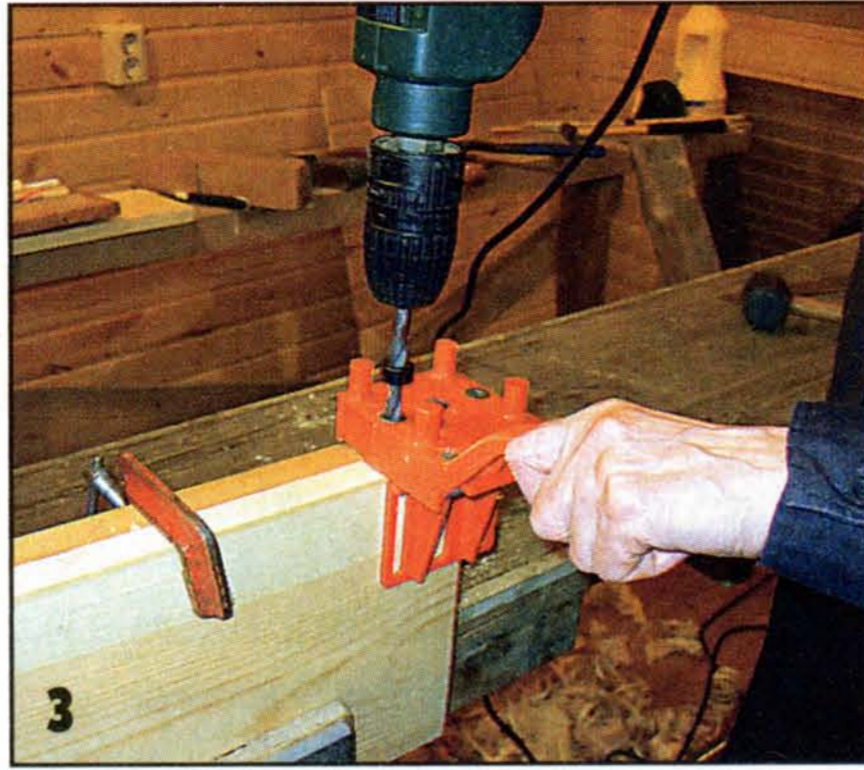
3 Установил шканты (пока — всухую) в отверстия центральной детали и, совместив её кромку с кромкой смежной детали, стянул эти детали струбцинами. Используя специальный кондуктор, просверлил ответные отверстия в кромке смежной детали точно напротив установленных шкантов.
