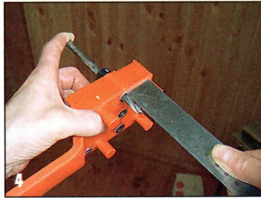
4 Ограничитель глубины сверления выставлял с учётом длины направляющей втулки кондуктора.
